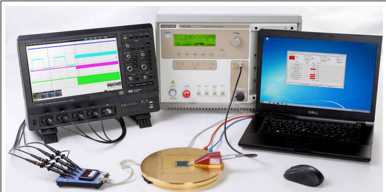
Bild 22 Oszilloskop-Adapter OA 4005 im Testaufbau mit dem Set ICE1 und dem Set 250
